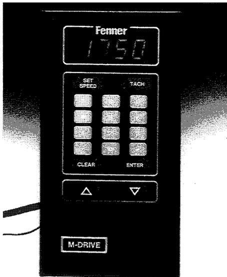
Figure 1-8: Operator Keypad
